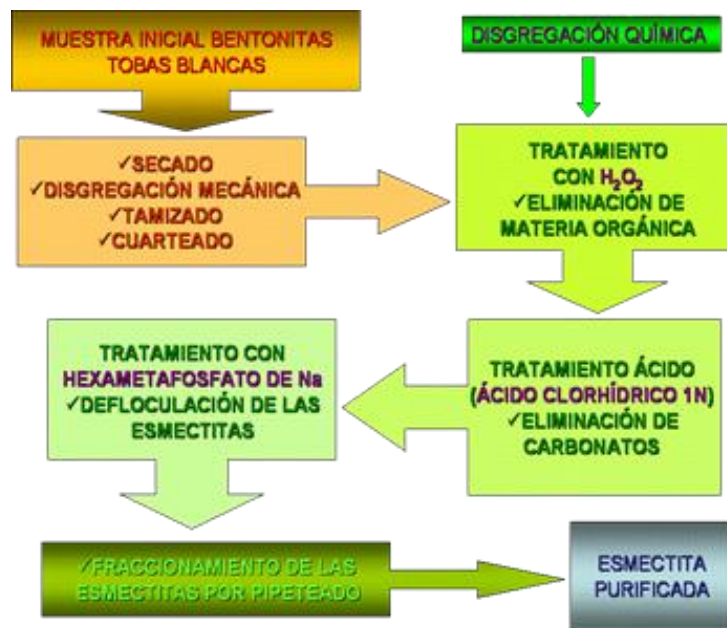
FIGURA 4. Esquema de las fases del tratamiento por las que ha pasado la muestra hasta obtener la fracción menor de 2\ \mu\text{m} (esmectitas tipo montmorillonita).
