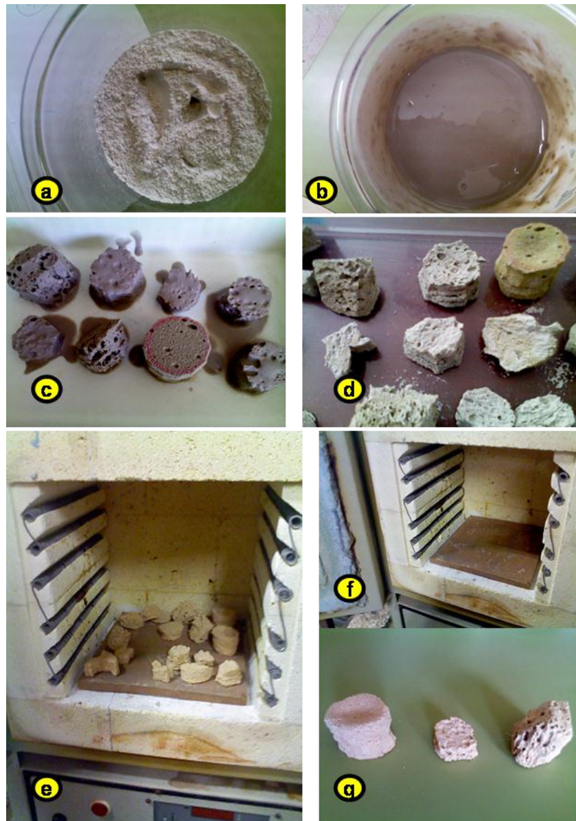
FIGURA 7. Imágenes del tratamiento del cerámico. a) Preparado con las esmectitas, CMC y el silicato de Na, b) Barbotina, c) Esponjas impregnadas de la barbotina, d) Secado, e) Cerámicos en el momento de extraerse del horno, f) Detalle del horno cerámico y g) Aspecto de los cerámicos a partir de la esponja de espuma de poliuretano, esponja de celulosa y esponja marina natural respectivamente.
