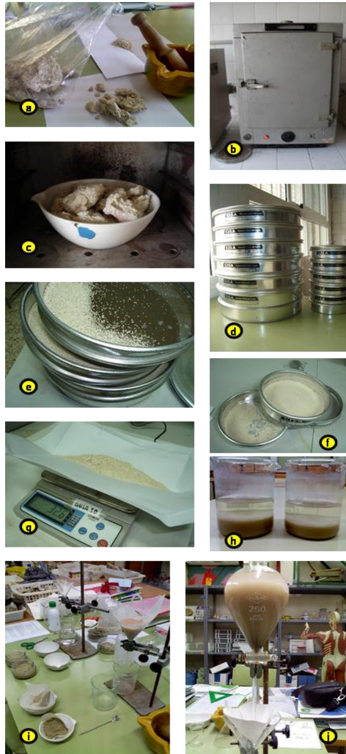
FIGURA 3. Fases de tratamiento a) Disgregación mecánica, b) Estufa, c) Secado de las muestras en la estufa, d) Columna de tamices, e) Separación de la fracción mayor de 2 mm, f) Separación de la fracción menor de 0,064 mm g) Pesaje de las fracciones h) Tratamiento ácido i) Lavado y filtrado y j) Pipeteado.
