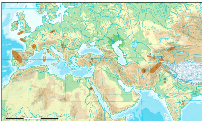
Figura 4. Fuentes de minerales de estaño (elaborado a partir de Berger et al. 2019) (1) Cornualles y Devon, Reino Unido (2) Montañas Mourne, Reino Unido (3) Bretaña, Francia (4) Massif Central, Francia (5) Portugal y Noroeste de España (6) Erzgebirge, Montes Metálicos, Alemania (7) Montes Metálicos, Eslovaquia (8) Monte Cer, Serbia (9) Monte Bukulja, Serbia (10) Monte Valerio, Italia (11) Cerdeña, Italia (12) Kestel, Turquía (13) Hisarcik, Turquía (14) Desierto Oriental, Egipto (15) Deh Hosein, Irán (16) Afganistán Occidental (17) Afganistán central y Noroccidental (18) Valle de Zerabšan, Uzbekistán (19) Montaña Hissar, Tayikistán (20) Pamir, Tayikistán (21) Kirguistán (22) Tosham, India (23) Distritos de Bastar y Koraput, India
